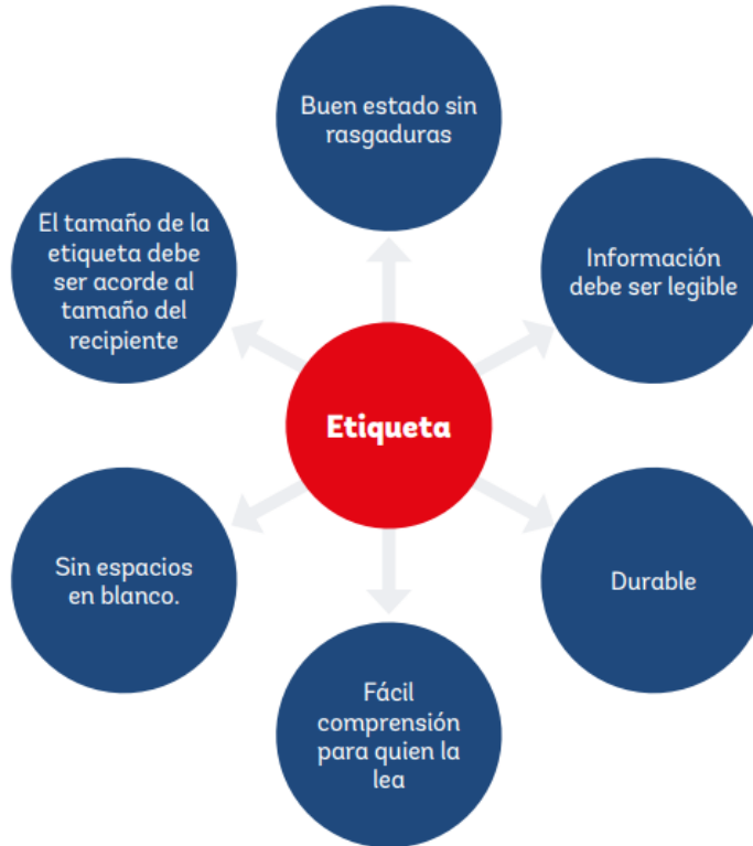
Ilustración 2. Diagrama de requerimientos a incluir dentro de las etiquetas de productos químicos
